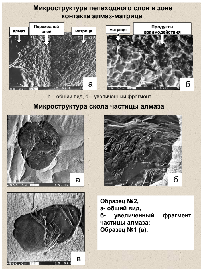
Рис. 8 Микроструктура переходного слоя алмаз-матрица.
