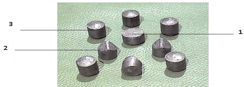
Рис.2 Породоразрушающие элементы из славутича
