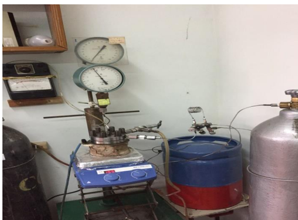
Сурет 1 - Олефиндерді металлокомплекті катализаторлар қатысында гидроэтерификациялау реакциясын жүргізуге арналған лабораториялық қондырғы сұлбасы
