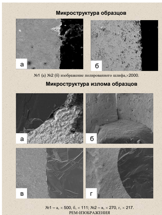
Рис. 5 Микроструктура образцов №1 и №2.
