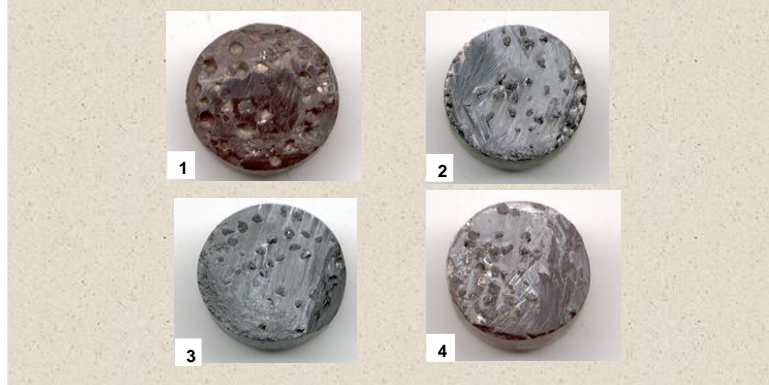
Рис.9 Вставки славутича после испытаний 1-вставка без CrB 2 , Вставки 2,3,4 с CrB 2
