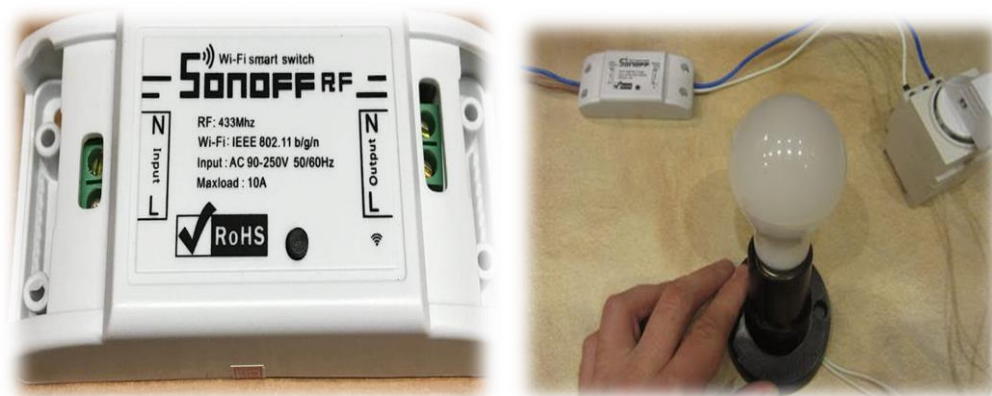
2- сурет Sonoff релесі және оны жалғау процесі
