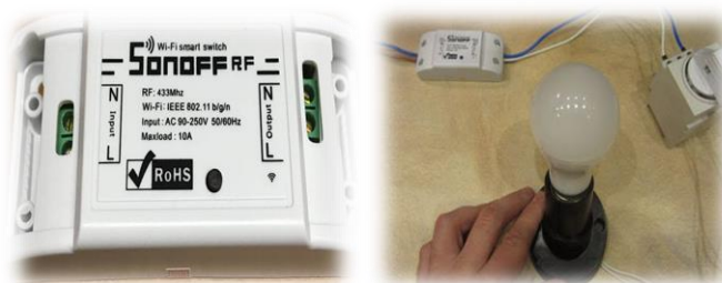
2- сурет Sonoff релесі және оны жалғау процесі
