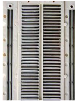
Сурет 3 – Монтаждау тақтасының алдыңғы және сыртқы беті.
